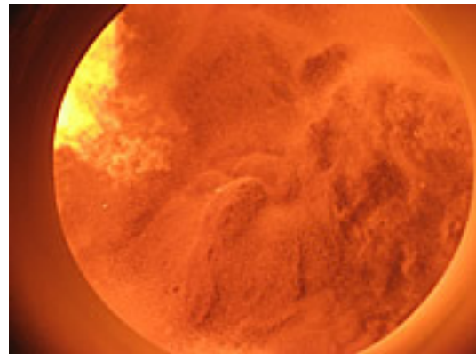
Verbrennung in der Wirbelschicht bei einem Klärschlammofen
