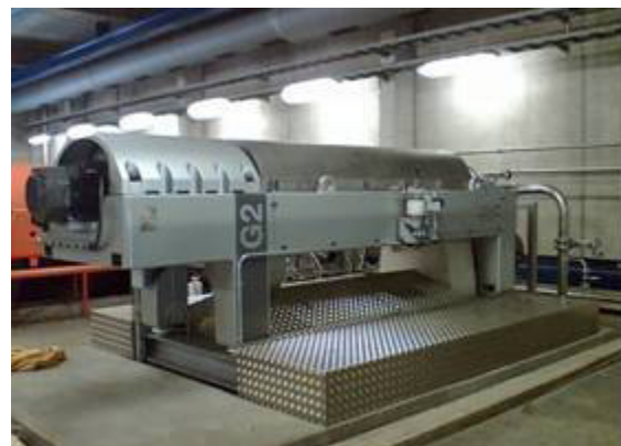
Entwässerung von Klärschlamm mittels Dekanter
